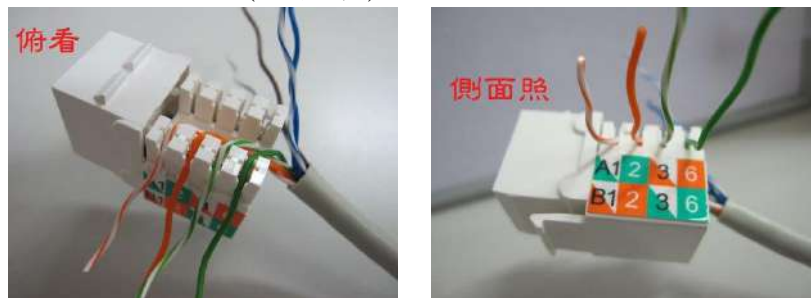
圖2 使用剝線器將網路線壓入電信插座中(選擇B1)
