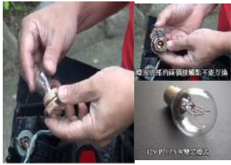
取出煞車燈燈座並分離燈泡
